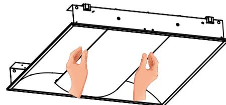
La fixation du cadre s'assure à l'aide des ressorts montés sur le corps du luminaire
